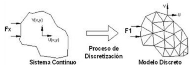
Figura 1.- Modelo discreto con elementos y nodos.
