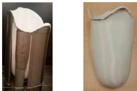
Figura 18 y 19.- Encaje fabricado en FDM con soportes y encaje limpio.
